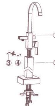
4. Соедините гибкую подводку с входными трубами.
