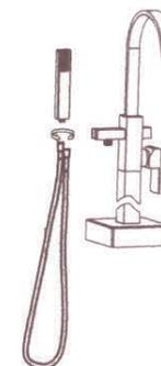
3. Установите, проложите входные трубы для гибких шлангов почертежом (входные трубы могут быть также гибкими и не обязательно монтироваться в пол, т.е. могут быть уложены вместе с отводом от ванны).
