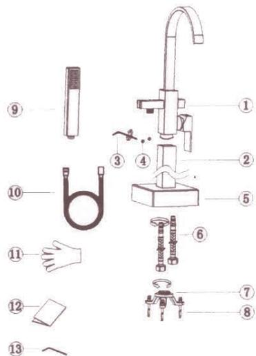
1. Присоедините гибкую подводку к корпусу смесителя, соедините корпус смесителя с трубой держателем, наденьте на трубу держатель накладку.
