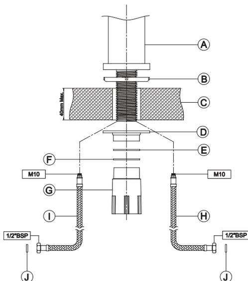
1. Для установки смесителя на рабочей поверхности/мойке (С) необходимо наличие сквозного отверстия диаметром 35 мм.
