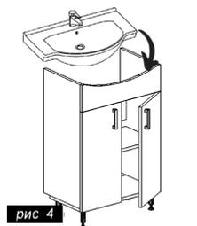
Установите раковину на тумбу, зафиксируйте ее на стене с помощью умывальников (не входят в комплект). Заполните зазорное расстояние между тумбой и раковиной, и между раковиной и стеной, силиконовым герметиком. (см. рис. 4).
