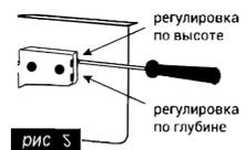
Обеспечьте плотное прилегание тумбы к раковине путем поворота основания регулируемых ножек для напольных изделий или используя систему регулирования навесов для подвесных изделий (см. рис. 5).
