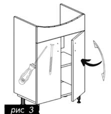
Установите тумбу максимально близко к стене, уровень может быть отрегулирован с помощью регулируемых ножек или навесов. Установите ручки с помощью крепежных винтов, освободив отверстия от пленки. (см. рис. 3).
