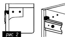
Подвесные изделия: устанавливаются при помощи регулируемых навесов, и могут крепиться с помощью монтажной рейки (не идет в комплекте), либо монтажных крючков с дюбелем (см. рис. 2).
