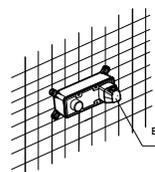
Установите корпус смесителя в монтажное отверстие и зафиксируйте его горизонтально. Перед укладкой стены необходимо предварительно снять защитную крышку
