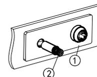
После установки декоративной накладки (1), вкрутите соединительный адаптер для излива (2), прижав панель к стене
