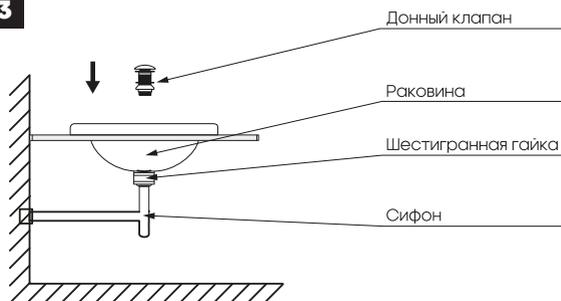
3. Установите донный клапан в сливное отверстие и зафиксируйте его с помощью шестигранной гайки. Подсоедините сифон.
