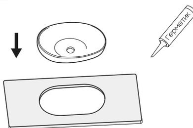
2. Обработайте место среза в столешнице герметизирующим составом, подходящим для выбранного материала столешницы. Нанесите тот же герметик на столешницу вокруг среза и на примыкающую к ней тыльную часть раковины. Вставьте раковину сверху в отверстие на столешнице и зафиксируйте её до полного высыхания связующего материала.
