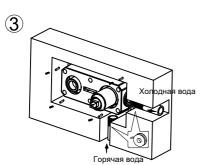
3 Установите встраиваемый корпус (поз. 2) в монтажное отверстие и закрепите его с помощью винтов. Откройте вентили и проверьте систему на герметичность.
