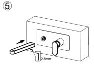
5. Прикрепите излив (поз. 1) к корпусу смесителя (поз. 3) и затяните.
