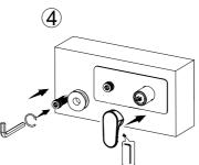
4. Закрепите декоративную панель (поз. 2) на корпусе (поз. 3). Снимите соединительный элемент с излива (поз. 1) и обмотайте его лентой. Подсоедините излив (поз. 1) к корпусу (поз. 3) и затяните ключом. Установите ручку управления (поз. 4) и закрепите с помощью крепежного комплекта (поз. 6).
