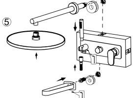
5. Прикрепите держатель (поз. 5). Подключите один конец шланга (поз. 6) к держателю (поз. 5), другой — к лейке (поз. 4). Закрепите трубу (поз. 8) на стене. Прикрутите верхний душ (поз. 9) к трубе (поз. 8). Затем прикрепите излив (поз. 10) к стене с помощью соединения.
