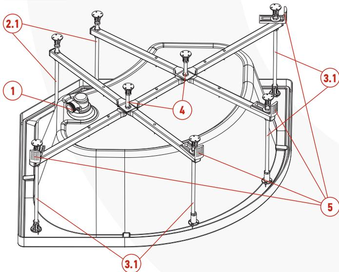
2.1 ШПИЛЬКА РЕЗЬБОВАЯ M12 360 мм
