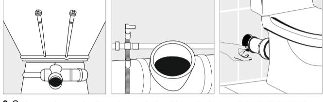
2. Соедините унитаз с выходом канализации с помощью отвода, определив место его расположения. Отметьте через монтажные отверстия постамента унитаза места сверления на поверхности пола под монтажные дюбели.
