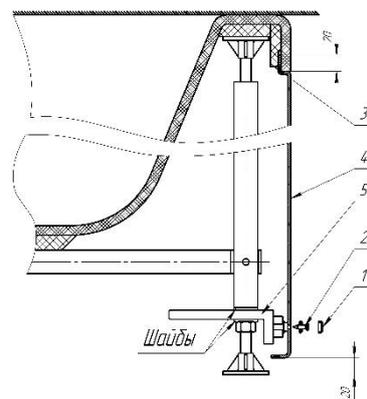
в) Крепление на шариковых фиксаторах
